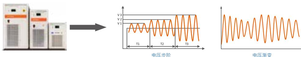
AFV 具有步阶的功能，用户可直接透过触摸屏设置电压或频率步阶，内建 24 组记忆组，最高可循环 255 次，广泛适用于电机类或家电类负载之性能测试。记忆组中可设置输出电压、输出频率、及每个步阶的运行时间。而内建 12 组电压渐变的记忆组，用户可远端或透过触摸屏设置电压或频率渐变，记忆组中可设置输出电压、输出频率、开始 / 结束组数及每组渐变的运行时间，最高可循环 255 次，此功能适用于电机类或家电类负载等测试。
